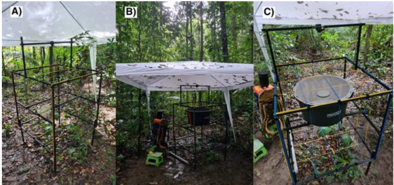
Abb.2: A) Der leere Aluminiumrahmen unter dem Zelt, B) die komplette Anlage mit Arena, Elektronik und Batterien und C) eine Nahaufnahme der Arena und des Ausstossrohrs.
